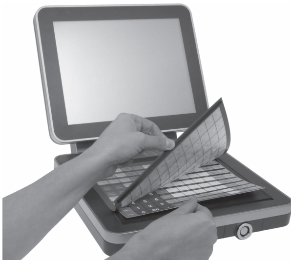
Abb. 13: Folientastatur anheben und Einlegeblatt ausrichten
