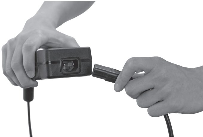
Abb. 24: Kaltgerätekupplung aus Kaltgeräteeinbaustecker ziehen
