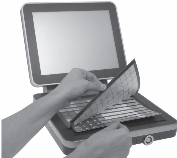
Abb. 25: Folientastatur anheben und Einlegeblatt ausrichten
