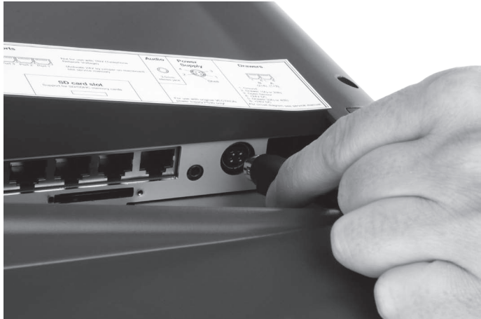
Abb. 23: Stromleitungsstecker aus Stromanschluss ziehen
