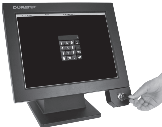
Abb. 10: Bedienschlüssel an das Bedienschloss halten
